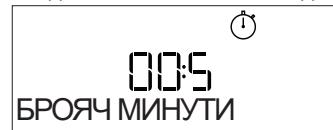
Ще се чуе звуков сигнал и ще се изведе индикация на дисплея след като таймерът завърши обратното отброяване на избраното време.
