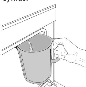
Po vybrání funkce „Vypustit vodu“ stiskněte
