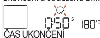
Stiskněte + nebo - pro nastavení času, kdy si přejete přípravu ukončit. Poté potvrďte stiskem ✓ a funkci spusťte. Vložte pokrm do trouby a zavřete dvířka: Funkce se spustí automaticky po určité době, která byla vypočtena tak, aby příprava pokrmu byla dokončena ve vámi nastaveném čase.
