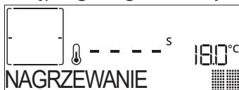
Po zakończeniu tej fazy, rozlegnie się sygnał dźwiękowy, a na wyświetlaczu pojawi się komunikat, że piekarnik osiągnął ustawioną temperaturę, wymaganą, aby „DODAJ POTRAWĘ”.
