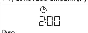
Vajutage nuppu + või — et valida soovitud tsükkel, seejärel vajutage kinnitamiseks nuppu ✓ . Kui tsükkel on valitud, vajutage aja (viitkäivitus) valimiseks nuppu + või — ja vajutage kinnitamiseks nuppu ✓ . Puastage uks ja eemaldage kõik tarvikud viidatud
