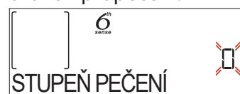
Po vyzvání stiskněte + nebo - a zvolte si požadovanou úroveň od rare (-1) po well done (+1). Stiskněte ✓ nebo ▶ pro potvrzení a aktivujte funkci. Stejným způsobem je u některých funkcí 6th Sense možné nastavit úroveň zapečení od nízké (-1) po vysokou (1).
