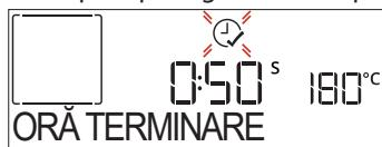
Apăsați + sau — pentru a seta ora la care doriți să se termine procesul de preparare, apoi apăsați ✓ pentru a confirma și activați funcția. Introduceți alimentele în cuptor și închideți ușa: Funcția va porni automat după calcularea perioadei de timp necesară pentru finalizarea preparării la ora setată.
