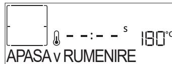
Atunci când pe afişaj apare mesajul aferent, dacă este necesar, apăsați pe  pentru a porni un ciclu de rumenire de cinci minute. Puteți opri funcția oricând apăsând  pentru a opri cuptorul.
