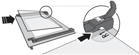
4. Replacez le bord supérieur : un déclic indique qu'il est bien placé. Assurez-vous que le joint est bien placé avant de remonter la porte.
