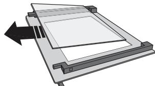
3. Replacez la paroi du milieu (marquée d'un « 1R ») avant de replacer la paroi intérieure : Pour placer correctement les parois de verre, assurez-vous que la marque « R » se trouve dans le coin gauche. En premier, insérez la longue partie de la vitre marquée d'un « R » dans les appuis des guides, abaissez-la ensuite en place. Répétez cette procédure pour les deux parois de verre.
