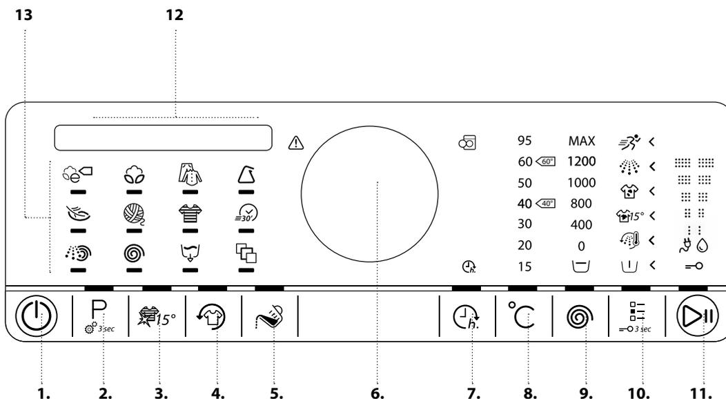
1. Tlačidlo „Zapnutie/Vypnutie“ („Reset/Vypustenie“ ak ho stlačíte a podržíte)
