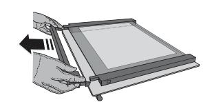
Zvedněte a oběma rukama pevně držte vnitřní sklo. Vysadte je a položte na měkký povrch. Poté začněte s čištěním (3).
