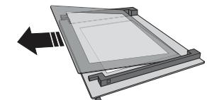
2 Per riposizionare correttamente il vetro interno, fare attenzione che la "R" sia leggibile nell'angolo destro e che la superficie lucida (non stampata) sia rivolta verso l'alto. Inserire dapprima il lato lungo del vetro indicato dalla "R" nelle sedi di sostegno, quindi abbassarlo in posizione (4). Rimontare il profilo superiore (5): un clic indica il corretto posizionamento. Verificare che la tenuta sia salda prima di rimontare la porta.
