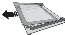
Aby ste správne vložili vnútorné sklo na miesto, dbajte, aby bolo v ľavom rohu viditeľné „R“ a čistý (nepotačený) povrch bol hore. Najprv vložte do opornej podložky dlhú stranu skla označenú „R“, potom ju spusťte na svoje miesto (4). Nasadte horný okraj (5). Ak je poloha správna, ozve sa kliknutie. Pred opäťovným nasadením dvierok sa presvedčte, či je tesnenie zaistené.
