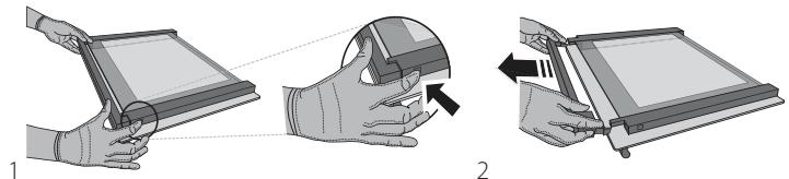
1 Sollevare e afferrare saldamente il vetro interno con due mani, rimuoverlo e appoggiarlo su un piano morbido prima di eseguire la pulizia (3).
