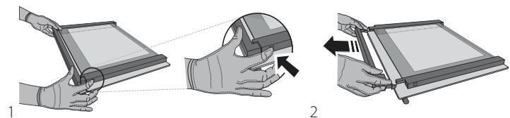
Zdvíhnite a pevne držte vnútorné sklo oboma rukami, vyberte ho a pred čistením položte na mäkký povrch (3).
