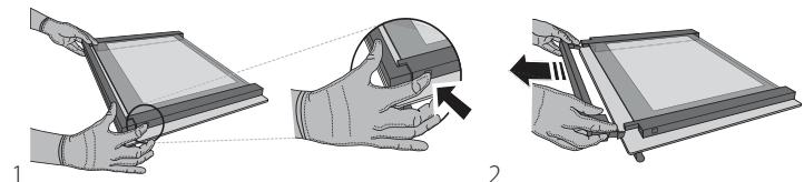
Σηκώστε και κρατήστε σταθερά το εσωτερικό τζάμι και με τα δύο χέρια, αφαιρέστε το και τοποθετήστε το σε μια μαλακή επιφάνεια πριν το καθαρίσετε (3).
