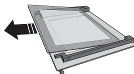
För att sätta tillbaka innerglaset korrekt, kontrollera att "R" är synligt i det vänstra hörnet och att den klara ytan (utan tryck) är vänd uppåt. Sätt först in glasets längsida som indikeras av "R" i dess hållare och sänk det sedan på plats (4). Sätt in den övre kanten (5). Ett klickljud anger att det är korrekt insatt. Försäkra dig om att tätningen är säker innan luckan monteras tillbaka.
