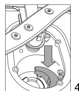
Μετά τον καθαρισμό των φίλτρων, επανατοποθετήστε το φίλτρο και στερεώστε το καλά στη θέση του. Αυτό είναι σημαντικό για να διατηρείται η αποτελεσματική λειτουργία του πλυντηρίου πιάτων.
