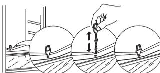
Pour assurer une évacuation constante et correcte de l'eau de dégivrage, nettoyez régulièrement l'intérieur de l'orifice d'évacuation situé sur la paroi arrière du compartiment réfrigérateur, à proximité du bac à fruits et légumes, à l'aide de l'outil fourni avec l'appareil.
