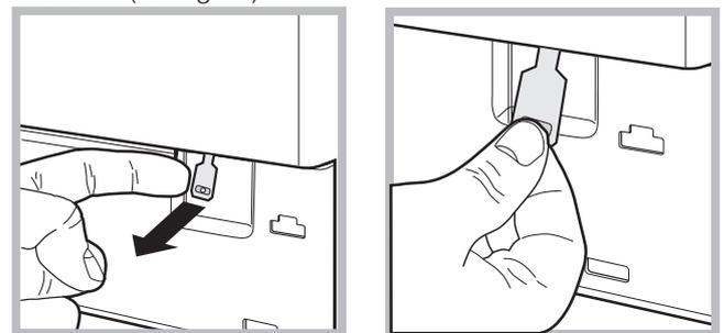
4. se servir de la languette indiquée, tirer vers soi jusqu'à ce que le tirant en plastique se dégage de son cran d'arrêt; tirer ensuite vers le bas et ouvrir l'hublot en même temps.
