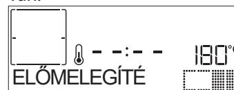
A szakasz végeztével hangjelzés hallható, és a kijelzőn üzenet jelzi, hogy a sütő elérte a megadott „ÉTEL HOZZAADÁSA” hőmérsékletet.
