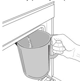
Po vybrání funkce „Vypustit vodu“ stiskněte **[D]** a provedte uváděné kroky: Otevřete dvírka a pod vypouštěcí trysku na spodní straně panelu vložte velkou nádobu. Jakmile se spustí vypouštění, držte nádobu na místě, dokud není proces dokončen. Průměrná doba odtoku vody při plném naplnění je přibližně
