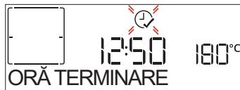
Apăsați + sau — pentru a seta ora la care dorîți să se termine procesul de preparare, apoi apăsați ✓ pentru a confirma și activați funcția. Introduceți alimentele în cuptor și închideți ușa: Funcția va porni automat după calcularea perioadei de timp necesară pentru finalizarea preparării la ora setată.
