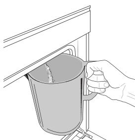
Odată selectată funcția „Evacuare”, apăsați pe  și urmați acțiunile indicate: Deschideți uşa și aşezați o carafă mare sub duza de evacuare amplasată în partea inferioară, în dreapta panoului. Odată începută evacuarea, mențineți carafa în poziție până când se finalizează operațiunea. Durata medie pentru evacuarea completă este de aproximativ trei minute.
