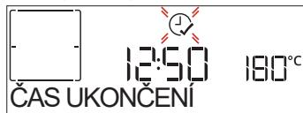
Stiskněte + nebo — pro nastavení času, kdy si přejete přípravu ukončit. Poté potvrďte stiskem ✓ a funkci spusťte. Vložte pokrm do trouby a zavřete dvířka: Funkce se spustí automaticky po určité době, která byla vypočtena tak, aby příprava pokrmu byla dokončena ve vámi nastaveném čase.
