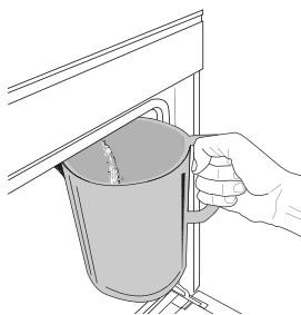
Kad ir atlasīta funkcija "Izliešana", nospiediet un veiciet norādītās darbības: Atveriet ierīces durvis un zem izliešanas sprauslas, kas atrodas paneļa apakšējā daļā pa labi, novietojiet lielu krūzi. Sākat izliešanu, turiet krūzi paredzētajā vietā, līdz izliešana ir pabeigta. Vidējais pilnas izliešanas ilgums ir apmēram trīs minūtes.
