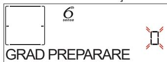
Atunci când vi se solicită acest lucru, apăsați pe + sau — pentru a selecta nivelul dorit, de la preparate în sânge (-1) la preparate bine făcute (+1). Apăsați ✓ sau ☰ pentru a confirma și porniți funcția. În același mod, unde este permis, pentru unele funcții 6<sup>th</sup> Sense, este posibilă reglarea nivelului de rumenire de la redus (-1) la ridicat (1).
