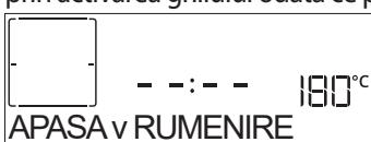
Atunci când pe afişaj apare mesajul aferent, dacă este necesar, apăsați pe  pentru a porni un ciclu de rumenire de cinci minute. Puteți opri funcția oricând apăsând pe butonul  pentru a opri cuptorul.
