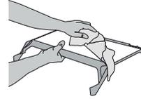
6. Setzen Sie das Zubehörteil wieder ein, indem Sie es hinten in die in der Abbildung dargestellten Aussparungen einführen und dann den Griff des Zubehörteils mit den Klammern oben verriegeln.
