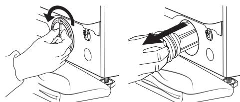
5. Curătați filtrul de apă: îndepărtați reziduurile din filtru și curătați-l sub jet de apă de la robinet.
