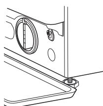
3. Evacuați apa: rotați încet filtrul în sens antiorar, până când toată apa s-a scurs. Lăsați apa să curgă fără a scoate filtrul. După ce recipientul este plin, închideți filtrul de apă rotindu-l în sens orar. Goliți recipientul. Repetați procedura până la evacuarea completă a apei.
