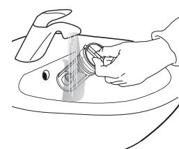
6. Introduceți filtrul de apă și instalați plinta la loc: reintroduceți filtrul de apă prin rotire în sens orar. Răsuciți-l în interior până când se oprește. Mânerul filtrului trebuie să fie în poziție verticală. Pentru a testa etanșeitatea la apă a filtrului de apă, puteți turna în jur de 1 litru de apă în distributiorul de detergent. Apoi, remontați plinta.
