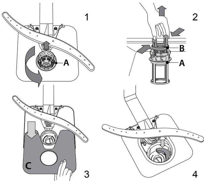
Μετά τον καθαρισμό των φίλτρων, επανατοποθετήστε το φίλτρο και στερεώστε το καλά στη θέση του. Αυτό είναι σημαντικό για να διατηρείται η αποτελεσματική λειτουργία του πλυντηρίου πιάτων.
