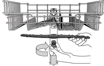
Pour enlever le bras d'aspersion supérieur, tournez l'anneau de verrouillage en plastique dans le sens horaire. Le bras d'aspersion supérieur doit être replacé de façon que le côté avec le plus grand nombre de trous est placé vers le haut.
