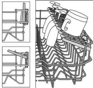
Messen en andere gebruiksvoorwerpen met scherpe randen moeten in de bestekmand worden gezet met de punten naar beneden gericht of horizontaal geplaatst in de opklapbare compartimenten op het bovenste rek.
