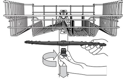
Para retirar o braço aspersor superior, rode o anel de bloqueio de plástico no sentido ao dos ponteiros do relógio. O braço aspersor superior deve ser recolocado de modo a que o lado com mais orifícios fique voltado para cima.
