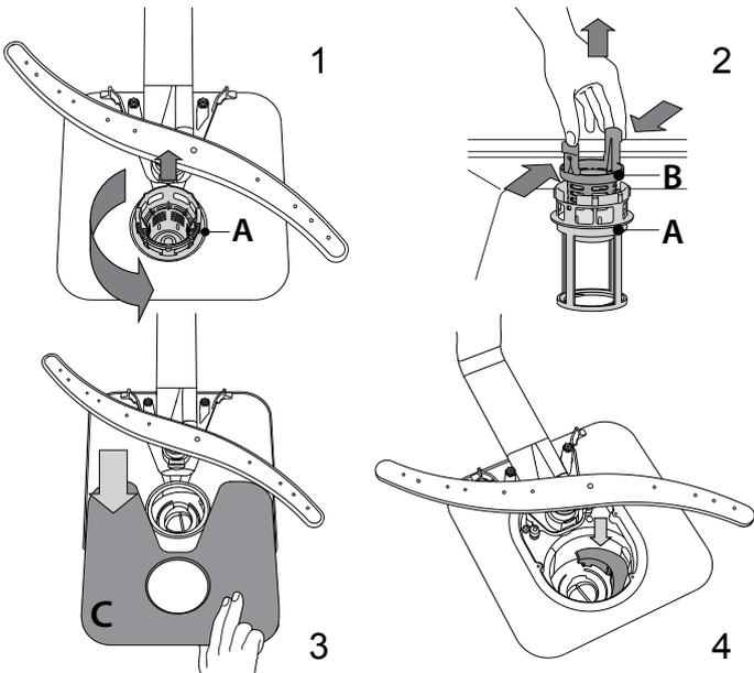
Na het schoonmaken van het filter het filtersysteem opnieuw plaatsen en goed op zijn plaats zetten; dit is essentieel voor het behoud van de efficiënte werking van de afwasmachine.
