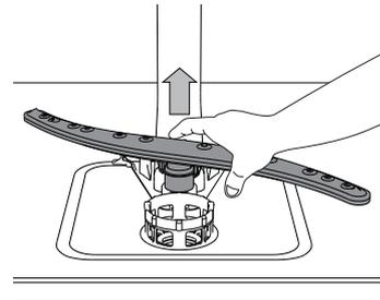
De onderste sproeiarm kan worden verwijderd door het omhoog te trekken.
