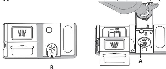
1. Open het doseerbakje B door de tab op het deksel in te drukken en omhoog te trekken.
