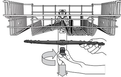
Voor het verwijderen van de bovenste sproeiarm de kunststof borgring rechtsom draaien. De bovenste sproeiarm moet worden vervangen, zodat de zijde met het grotere aantal openingen naar boven is gericht.
