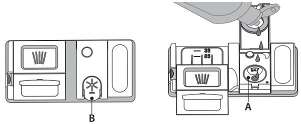
1. Abra el dispensador **B** pulsando y levantando la lengüeta de la tapa.
