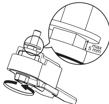
Als de vriezerdeur lager is dan de koelkastdeur kan de vriezerdeur worden verhoogd door de stelschroef tegen de klok in te draaien met behulp van een M10 moersleutel.
