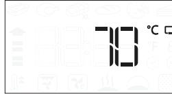
Als de gaarthermometer wordt aangesloten tijdens de selectie van een functie, schakelt het display over naar de voorgeprogrammeerde doeltemperatuur van de gaarthermometer.
