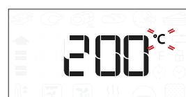
Wanneer het  $^{\circ}\text{C}/^{\circ}\text{F}$  pictogram knippert op het display draai dan aan de knop om de waarde te veranderen, druk daarna op om te bevestigen en ga verder met het wijzigen van de instellingen die volgen (indien mogelijk). U kunt tegelijkertijd ook het grillniveau instellen (3 = hoog, 2 = gemiddeld, 1 = laag).
