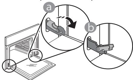
enquanto a puxa, simultaneamente, para cima, até se libertar do respetivo suporte. Coloque a porta de parte, apoiando-a sobre uma superfície suave.
