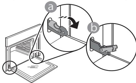
tegelijkertijd omhoog te trekken totdat het loshaakt. Zet de deur opzij en laat deze op een zachte ondergrond rusten.
