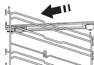
Fixe o encaixe superior da corrediça à guia de nível e faça-a deslizar até parar. Baxe o outro encaixe para o posicionar.
