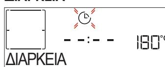
Όταν αναβοσβήνει το εικονίδιο ☰ στην οθόνη, πατήστε το + ή το — για να ρυθμίσετε το χρόνο που απαιτείται για να ολοκληρωθεί το μαγείρεμα, στη συνέχεια πατήστε το ✓ για επιβεβαίωση. Δεν χρειάζεται να ρυθμίσετε το χρόνο ψησίματος αν θέλετε να διαχειριστείτε το ψήσιμο μη αυτόματα (χωρίς χρόνο ψησίματος): Πατήστε το ✓ ή το ☰ για επιβεβαίωση και έναρξη της λειτουργίας. Επιλέγοντας αυτή τη λειτουργία, δεν μπορείτε να προγραμματίσετε καθυστερημένη έναρξη της λειτουργίας.
