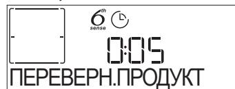
Пролунає звуковий сигнал і на дисплей буде відображене дію, яку потрібно виконати. Відкрийте дверцята, виконайте запропоновану дію, що відображається на дисплей, після цього закройте дверцята і продовжіть готовування.
