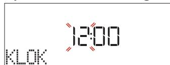
Druk op + of - om het huidige uur in te stellen en druk op ✓: Op het display knipperen de twee cijfers die de minuten aangeven. Druk op + of - om de minuten in te stellen en druk op ✓ om te bevestigen.
