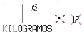
Para configurar la función correctamente, siga las indicaciones en la pantalla cuando se muestren y pulse + o — para establecer el valor deseado, después pulse ✓ para confirmar.
