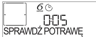
Urządzenie wyda sygnał dźwiękowy, a na wyświetlaczu pojawi się wskazówka mówiąca o konieczności wykonania czynności. Sprawdzić potrawę, zamknąć
