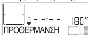
Μόλις ολοκληρωθεί αυτή η φάση, εκπέμπεται ένα ηχητικό σήμα και στην οθόνη εμφανίζεται η ένδειξη ότι ο φούρνος έφτασε στην επιλεγμένη θερμοκρασία και θα σας ζητηθεί η "ΤΟΠΟΘΕΤΗΣΗ ΦΑΓΗΤΟΥ".
