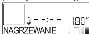
Po zakończeniu tej fazy, rozlegnie się sygnał dźwiękowy, a na wyświetlaczu pojawi się komunikat, że piekarnik osiągnął ustawioną temperaturę, wymaganą, aby „DODAJ POTRAWĘ”. W tym momencie należy otworzyć drzwiczki, włożyć potrawę do piekarnika, zamknąć drzwiczki i rozpoczęć pieczenie.
