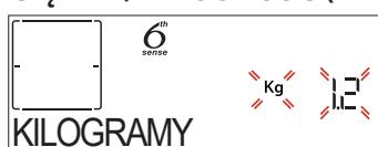
Aby poprawnie ustawić funkcję, należy kierować się wskazówkami na wyświetlaczu. Gdy pojawi się odpowiedni komunikat, wciśnąć + lub —, aby ustawić żądaną wartość, po czym zatwierdzić przyciskiem ✓.
