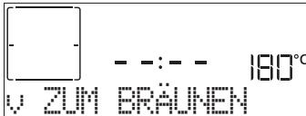
Wenn das Display die entsprechende Nachricht anzeigt, bei Bedarf **✓** drücken, um einen fünfminütigen Bräunungszyklus zu starten. Die Funktion kann jederzeit durch Drücken von **①** gestoppt werden, um den Ofen auszuschalten.
