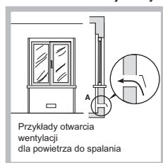
Pomieszczenie przyległe Pomieszczenie przeznaczone do przewietrzania Zwiększenie szczeliny pomiędzy drzwiami a podłogą
