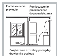
Przykłady otwarcia wentylacji dla powietrza do spalania
