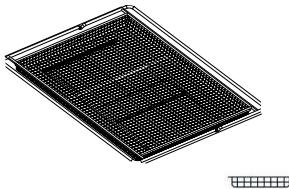
Poate fi utilizată atunci când gătiți alimente cu funcția Prăjire cu aer, cu o tavă de copt poziționată la un nivel inferior pentru a colecta eventualele firimituri și picături. Aceasta poate fi spălată în mașina de spălat vase.
