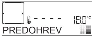
Po skončení tejto fázy sa ozve zvukový signál a na displeji sa ukáže, že rúra dosiahla nastavenú teplotu a treba PRIDAŤ JEDLO. V tejto chvíli otvorte dvierka, vložte jedlo do rúry, zatvorte dvierka a začnite pečenie stlačením ✓ alebo ▶.
