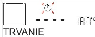
Ked' na displeji bliká ikonka stlačením alebo — nastavte požadovaný čas prípravy jedla a potvrďte stlačením . Dobu prípravy jedla nastavovať nemusíte, ak chcete riadiť pečenie manuálne (bez nastavenia času): Stlačením alebo potvrdíte a spustíte funkciu. Po zvolení tohto režimu nemôžete naprogramovať odložený štart.
