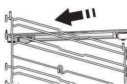
Demontați ghidajele pentru grătar din cuptor și îndepărtați folia protectoare din plastic de pe șinele culisante.
