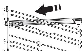
Z trouby odstraňte boční vodicí mřížky a z posuvných drážek ochranné fólie.
