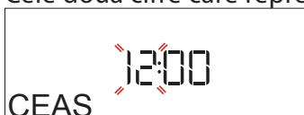
Apăsați pe + sau — pentru a seta ora corectă și apăsați pe ✓: Cele două cifre care reprezintă minutele vor clipe pe afișaj. Apăsați pe + sau — pentru a seta minutele și apăsați pe ✓ pentru a confirma.
