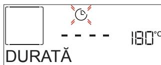
Când pictograma clipește pe afișaj, apăsați pe sau pentru a seta durata de preparare dorită, iar apoi apăsați pe pentru a confirma. Nu este necesar să setați durata de preparare dacă doriți să gestionați manual procesul de preparare (necronometrat): Apăsați pe sau pentru a confirma și a activa funcția. Prin selectarea acestui mod, nu puteți programa o pornire temporizată.
