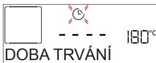
Když ikona bliká na displeji, stiskněte + nebo — pro nastavení požadované doby přípravy a poté pro potvrzení stiskněte ✓. Dobu pečení nemusíte nastavovat, pokud si přejete pečení ředit ručně (bez použití časovače): Stiskem ✓ nebo potvrďte a spusťte funkci. V tomto režimu nelze naprogramovat odložený start.
