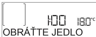
Zaznie zvukový signál a na displeji sa zobrazí správa, čo treba urobiť. Otvorte dvierka, vykonajte úkon požadovaný na displeji, zatvorte dvierka a po stlačení ▶ bude príprava jedla pokračovať.
