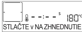
Keď sa na displeji zobrazí príslušné hlásenie, v prípade potreby stlačte ✓ na spustenie päťminútového cyklu zapečenia do hneda. Funkciu môžete kedykoľvek zastaviť stlačením ⊞, čím sa rúra vypne.
