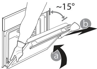
**3.** Dvířka opět nasadíte tak, že je přiložíte k troubě, nasměrujete háčky pantů oproti jejich usazení a do příslušného usazení zajistíte i horní část.
