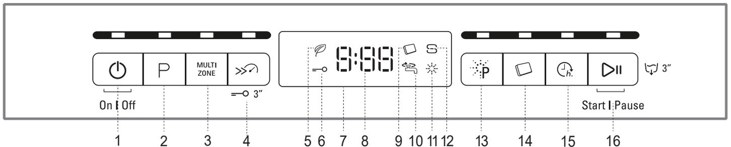
1. Ein-Aus/Reset Taste mit Anzeigelicht
