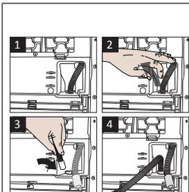
1-2 Rimuovere il tubo flessibile dietro l'asciugatrice tirandolo manualmente da dove è attaccato. Non usare un attrezzo per rimuovere il tubo.
