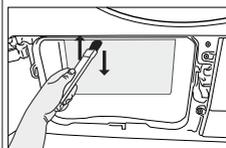
Pulire la fibra sulla superficie metallica del condensatore con un panno umido o la spazzola sul deflettore dell'aria in direzione su - giù. Non pulire con la direzione destra-sinistra perché danneggia le piastre metalliche del condensatore. Sarà possibile usare un aspirapolvere con una spazzola per la pulizia. Se l'aspirapolvere non dispone di una spazzola, sconsigliamo di usarlo per la pulizia del condensatore.
