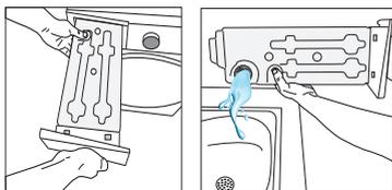
Se si accumulano fibre nell'imbuto del serbatoio dell'acqua, rimuoverle sotto l'acqua corrente. Rimettere in posizione il serbatoio dell'acqua.
