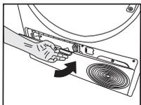
Dopo aver completato il processo di pulizia, rimettere il coperchio del deflettore dell'aria in posizione, spostare i fermi per chiuderlo e chiudere lo zoccolo base.
