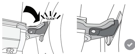
**5.** Versuchen, die Tür zu schließen und sicherstellen, dass sie auf das Bedienfeld ausgerichtet ist. Ist dies nicht der Fall, die oben aufgeführten Schritte wiederholen: Die Tür könnte beschädigt werden, wenn dies nicht richtig funktioniert.
