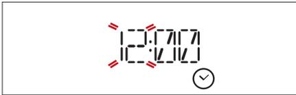
Den *Einstellknopf* drücken, um die korrekte Uhrzeit einzustellen und  $\frac{OK}{select}$  drücken: Auf dem Display blinken die beiden Minutenziffern.
