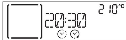
Note: programmare l'avvio ritardato di una cottura, disattiva in ogni caso la fase di preriscaldamento del forno: la temperatura desiderata viene raggiunta gradualmente, quindi i tempi di cottura si allungheranno leggermente rispetto a quanto indicato nella tabella di cottura.
