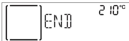
Drücken Sie den *OK select* Knopf, um den Garvorgang in manuellem Modus fortzusetzen (ohne eine programmierte Garzeit) oder den *Einstellknopf* drehen, um die Garzeit durch Einstellen einer neuen Dauer zu verlängern. In beiden Fällen werden die Einstellungen der Temperatur bzw. der Grillstufen beibehalten.
