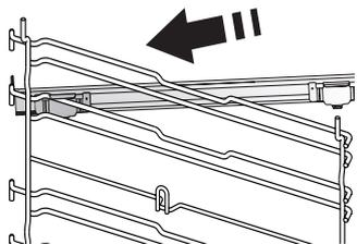
Ancorare alla griglia laterale la clip superiore della guida e farla scivolare fino a fine corsa; abbassare in posizione l'altra clip.
