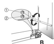
5. Använd den medföljande nyckeln när du ska reglera höjden på justeringsskruvarna. Vrid medurs för att höja och moturs för att sänka. Det kan vara nödvändigt att skruva flera varv på justeringsskruvarna eller fötterna för att få rätt lutning på kylskåpet.
