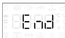
Para alargar el tiempo de cocción sin cambiar los ajustes, gire el selector para programar un nuevo tiempo de cocción y pulse
