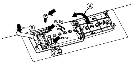
**Il collegamento alla rete elettrica deve essere effettuato tramite un sezionatore onnipolare avente una distanza minima fra i contatti di 3 mm.**
