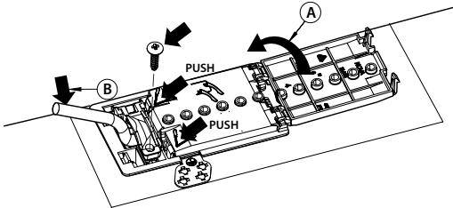
Η συσκευή πρέπει να συνδεθεί στην τροφοδοσία ρεύματος μέσω ενός πολυπολικού διακόπτη αποσύνδεσης με ελάχιστο διάστημα επαφής 3 mm.
