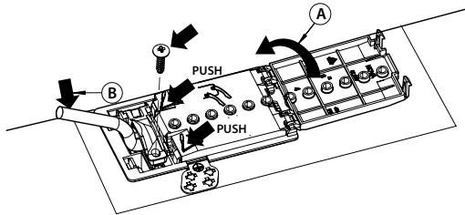
**Apparatet må koples til strømnettet ved bruk av en flerpolet skillebryter med en kontaktåpning på minst 3 mm.**
