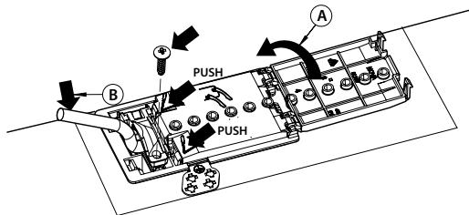
**Spotřebič musí být ke zdroji el. napájení připojen pomocí všeponového odpojovacího zařízení s minimální vzdáleností mezi kontakty 3 mm.**
