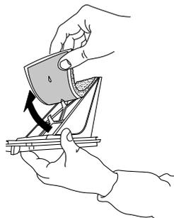
Enlevez la mousse du filtre inférieur, pour le nettoyer. Nettoyez la mousse du filtre et le filtre à la main ou sous l'eau courante. Ne le lavez pas dans la machine à laver. Essorez la mousse du filtre. Ne l'insérez pas dans le filtre inférieur trop humide.
