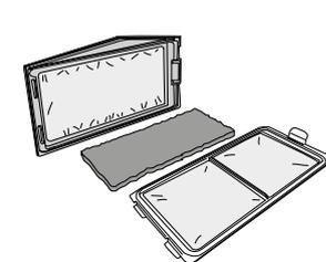
Fixez la mousse de filtre sur le filtre inférieur. Nettoyez la chambre du filtre de la sècheuse avec un chiffon humide ou minutieusement avec un aspirateur. Réinsérez le filtre inférieur. Refermez la poignée de filtre et fermez le volet inférieur.
