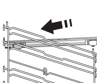
Z trouby odstraňte boční vodicí mřížky a z posuvných drážek ochranné fólie.
