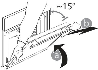
**3.** Dvířka opět nasadíte tak, že je přiložíte k troubě, nasmířujete háčky pantů oproti jejich usazení a do příslušného usazení zajistíte i horní část.
