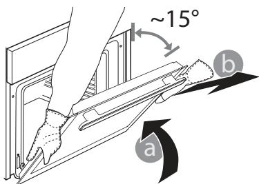
**3.** Įstatydami dureles pastumkite jas link orkaitės, suligiuokite vyrių kabiukus tvirtinimo vietose ir užfiksuodami viršutinę dalį.
