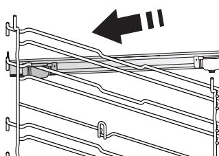
Vyberte vodiacie lišty z rúry a z posuvných bežcov odstráňte ochranné plasty. Pripojte vrchnú svorku bežca na vodiacu lištu a nasuňte, pokiaľ to ide. Druhú svorku spustite na miesto.
