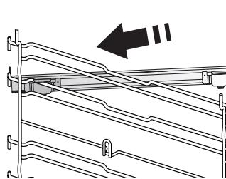
Išimkite lentynų laikiklius iš orkaitės ir nuimkite apsaugines plastikines dalis nuo slankiojančių grotelių. Viršutinių grotelių fiksatorių pritvirtinkite prie skersinių grotelių ir nustumkite jų į galą. Į tą padėtį nuleiskite ir kitą fiksatorių.
