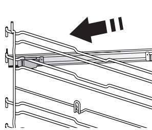
Demontați ghidajele pentru grătar din cuptor și îndepărtați folia protectoare din plastic de pe șinele culisante.
