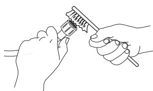
3. Ezután csavarja le kézzel a vízbevezető csövet a mosogép hátljáról. Fogóval húzza ki a hálós szűrőt a mosogép hátlján lévő szelepből, és óvatosan tisztítsa meg.
