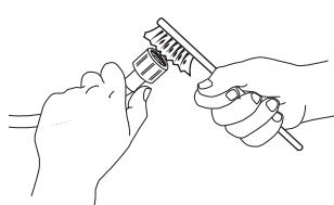
3. Ranka atsukite skalbyklės gale esančią įleidimo žarną. Replémis ištraukite tinklinį filtrą iš skalbyklės gale esančio vožtuvu ir atsargiai ji išvalykite.
