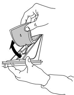
Enlevez la mousse du filtre inférieur, pour le nettoyer. Nettoyez la mousse du filtre et le filtre à la main ou sous l'eau courante. Ne le lavez pas dans la machine à laver. Essorez la mousse du filtre. Ne l'insérez pas dans le filtre inférieur trop humide.
