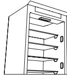
Dieses Produkt enthält 4 seitliche Lichtquellen der Energieeffizienzklasse F und eine obere Lichtquelle der Energieklasse G
