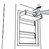
2. Maak het STOP FROST-accessoire los en verwijder het, let erop dat u het niet op de glasplaat eronder laat vallen.
