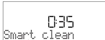
Premere  $\triangleright$  per attivare la funzione: il display indicherà le operazioni richieste per ottenere una pulizia ottimale: seguire le indicazioni e quindi premere  $\checkmark$ . Una volta eseguite tutte le operazioni preliminari, alla richiesta del forno premere  $\square$  per attivare il ciclo di pulizia.
