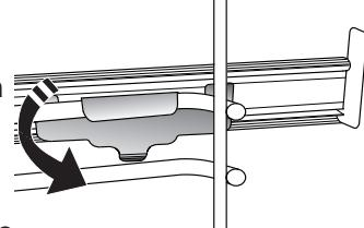
Nota: As corrediças podem ser instaladas em qualquer nível.
