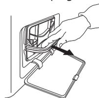
Enlevez la mousse du filtre inférieur, pour le nettoyer. Nettoyez la mousse du filtre et le filtre à la main ou sous l'eau courante. Ne lavez pas la mousse du filtre dans la machine à laver. Essorez la mousse du filtre. Ne l'insérez pas dans le filtre inférieur trop humide.
