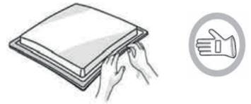
Posicione a placa sobre a abertura da bancada que foi feita respeitando as dimensões indicadas nas Instruções.
