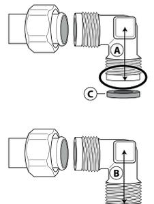
**IMPORTANTE:** Antes da ligação, remova a tampa para o transporte do furo de engate do tubo do gás do plano de cozedura.
