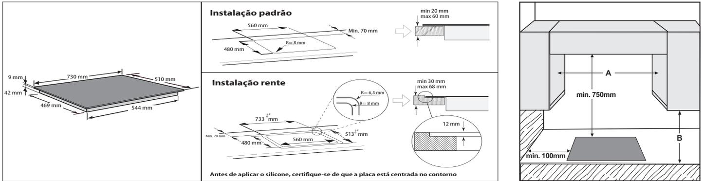
**NOTA:** se a distância "A" entre a parede dos armários for entre 600 mm e 730 mm, a altura "B" terá de ser, no mínimo, de 530 mm. Se a distância "A" entre a parede dos armários for maior do que a largura da placa, a altura "B" terá de ser, no mínimo, de 400 mm. Em caso de instalação de um exaustor por cima da placa, consulte as instruções do exaustor para uma distância correcta.
