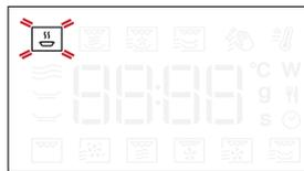
Drehen Sie den *Knopf*, um in der rechten Anzeige zwischen den verfügbaren Unterfunktionen auszuwählen, und drücken Sie zum Bestätigen die mittlere Taste. Die ausgewählte Unterfunktion blinkt, bis sie bestätigt wird.
