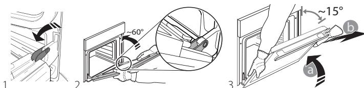
Положите дверцу на мягкую поверхность. Для установки дверцы поднесите ее к духовке, совместите крюки петель с гнездами и вставьте верхние части петель в гнезда. Опустите дверцу, а затем полностью откройте ее. Поверните фиксаторы в исходное
