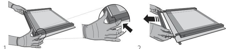
Поднимите внутреннее стекло, крепко удерживая его обеими руками, затем снимите и перед очисткой положите его на мягкую поверхность (3).
