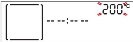
Wenn der Wert auf dem Display blinkt, den *Einstellknopf* drehen, um den Wert zu ändern; dann mit der *Auswahl-/Bestätigungstaste* bestätigen und die folgenden Einstellungen ändern (wenn möglich).
