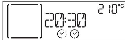
Hinweise: Die Programmierung einer verzögerten Garstartzeit deaktiviert die Ofenvorheizphase: Der Ofen erreicht die gewünschte Temperatur schrittweise, dies bedeutet, dass die Garzeiten etwas länger sind, als in der Gartabelle angegeben.
