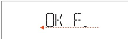
Wenn das Display die entsprechende Nachricht anzeigt, bei Bedarf die *Auswahl-/Bestätigungstaste* drücken, um einen fünfminütigen Bräunungszyklus zu starten.
