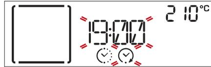
Den *Einstellknopf* drehen, um das gewünschte Garende einzustellen, dann mit *Auswahl-/Bestätigungstaste* bestätigen und die Funktion starten. Die Speise in den Ofen stellen und die Tür schließen: Die Funktion startet automatisch nach der berechneten Zeit, damit der Garvorgang zur eingestellten Zeit endet.
