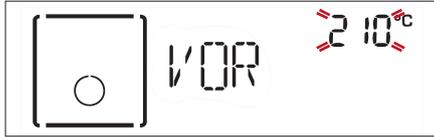
Sobald diese Phase beendet ist, ertönt ein akustisches Signal und das Display zeigt an, dass der Backofen die eingestellte Temperatur erreicht hat.
