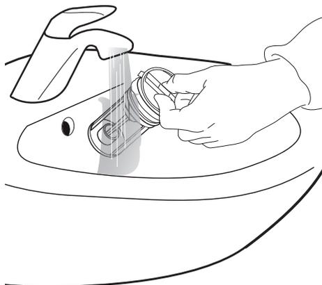
**6.** Insérez le filtre à eau et replacez le panneau de seuil de porte : Replacez le filtre à eau en le tournant dans le sens horaire. Tournez le plus possible ; la poignée du filtre devrait être en position verticale. Pour vérifier l'étanchéité du filtre, versez environ un litre d'eau dans le distributeur de détergent. Replacez le panneau de seuil de porte.
