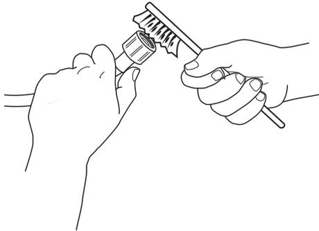
**3.** Ensuite, dévissez à la main le tuyau d'arrivée d'eau de l'arrière de la laveuse/sécheuse. En utilisant des pinces, enlevez le filtre à tamis de la soupape à l'arrière de la laveuse/sécheuse et nettoyez-le.
