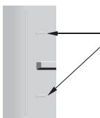
**Sur certains modèles :** pendant le chargement du compartiment de congélation, ne chargez pas au-delà des lignes de chargement, autrement la porte risque de ne pas se fermer correctement.
