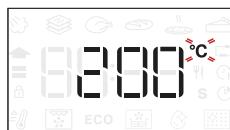
Wenn das Symbol auf dem Display blinkt, den Knopf drehen, um den Wert zu ändern, anschließend zur Bestätigung drücken und fortfahren, um die nachfolgenden Einstellungen zu ändern (falls möglich).
