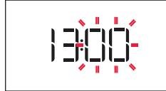
Op het display knipperen de twee cijfers die de minuten aangeven. Draai aan de knop om de minuten in te stellen en druk op
