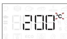
Cuando el icono °C parpadee en la pantalla, gire el mando para modificar el valor y, a continuación, pulse para confirmar y continuar modificando los ajustes siguientes (si es posible).
