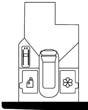
2. Para encher o detergente líquido (à esquerda) e o amaciador (à direita), abra a tampa do respectivo reservatório para cima, como indicado na figura.
