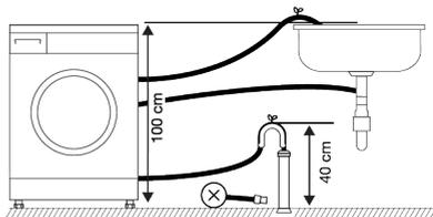
4. Para evitar que a água usada volte a entrar no produto e para assegurar um escoamento fácil, não submergir a extremidade da mangueira na água usada ou não inserir a mesma no escoamento mais de 15 cm. Se for demasiado comprida, cortá-la.
