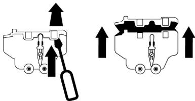
7. Remova as abas que prendem a tampa superior da gaveta de detergente com uma chave de fenda (existem 6 abas no total, duas à direita, esquerda e traseira da gaveta) e lave o interior da gaveta.
