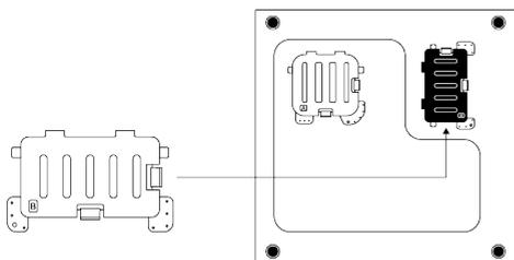
Assentar as guias da Tampa B contra o painel inferior. Completar a montagem rodando a tampa.
