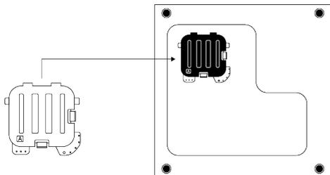
Inclinar a máquina ligeiramente para trás. Assentar as guias da Tampa A contra o painel inferior. Completar a montagem rodando a tampa.
