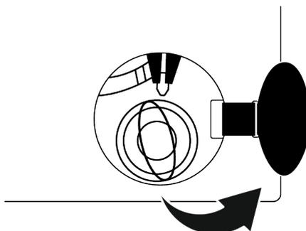
3. Empurrar a pega de emergência da porta de carregamento para a abrir. Em seguida, abrir a porta de carregamento.
