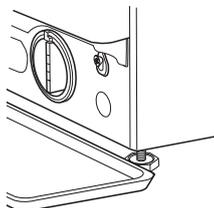
3. Voer het water af: draai het filter langzaam naar links tot al het water naar buiten is gelopen. Laat het water naar buiten stromen zonder het filter te verwijderen. Zodra de bak vol is, sluit u het waterfilter door het naar rechts te draaien. Leeg de bak. Herhaal de procedure tot al het water is afgevoerd.
