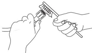
3. Schrauben Sie nun den Zulaufschlauch auf der Rückseite der Waschmaschine mit der Hand ab. Ziehen Sie den Siebfilter mit einer Zange aus dem Ventil auf der Rückseite der Waschmaschine heraus und reinigen Sie ihn vorsichtig.
