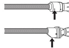
Bei Schläuchen mit Aquastop: Prüfen Sie das kleine Kontrollfenster des Sicherheitsventils (siehe Pfeil). Wenn es rot ist, wurde die Aquastop-Funktion ausgelöst und der Schlauch muss durch einen neuen ersetzt werden.
