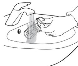
6. Setzen Sie den Wasserfilter ein und bringen Sie die Sockelblende wieder an: Setzen Sie den Wasserfilter wieder ein, indem Sie ihn im Uhrzeigersinn drehen. Achten Sie darauf, ihn bis zum Anschlag hineinzudrehen. Der Filtergriff muss sich in vertikaler Position befinden. Um zu testen, ob der Filter dicht ist, können Sie ungefähr einen Liter Wasser in das Waschmittelfach gießen. Bringen Sie anschließend die Sockelblende wieder an.
