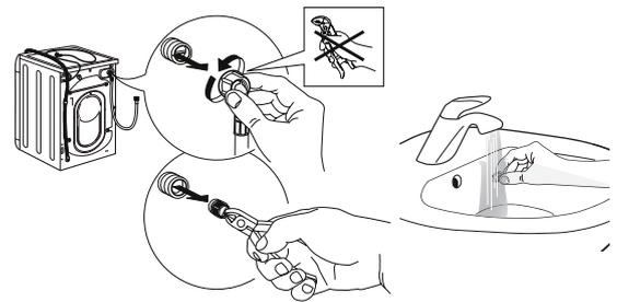
4. Setzen Sie den Siebfilter wieder ein. Schließen Sie den Zulaufschlauch erneut am Wasserhahn und an der Waschmaschine an. Verwenden Sie zum Anschließen des Zulaufschlauchs keine Werkzeuge. Öffnen Sie den Wasserhahn und prüfen Sie, ob alle Anschlüsse dicht sind.
