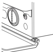
3. Zum Ablassen des Wassers: Drehen Sie den Filter langsam gegen den Uhrzeigersinn, bis das gesamte Wasser ausgetreten ist. Lassen Sie das Wasser abfließen, ohne den Filter zu entfernen. Wenn der Behälter voll ist, schließen Sie den Wasserfilter, indem Sie ihn im Uhrzeigersinn drehen. Entleeren Sie den Behälter. Wiederholen Sie den Vorgang, bis das gesamte Wasser abgelassen ist.
