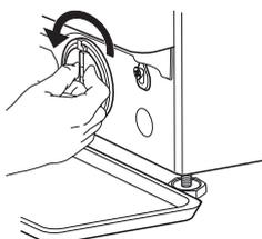
4. Verwijder het filter: leg een katoenen doek onder het waterfilter, die een kleine hoeveelheid restwater kan absorberen. Verwijder vervolgens het filter door het naar links eruit te draaien.
