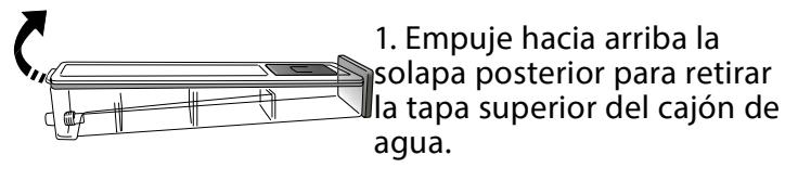
1. Empuje hacia arriba la solapa posterior para retirar la tapa superior del cajón de agua.
