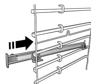
Extraiga las guías para los estantes del horno y quite el plástico de protección de las guías deslizantes.
