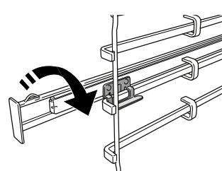
Per fissare la guida, premere la parte inferiore della clip contro la griglia laterale. Assicurarsi che le guide possano scorrere liberamente. Ripetere questa operazione sull'altra griglia laterale, allo stesso livello.
