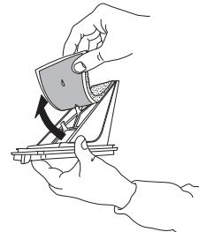
Fixez la mousse de filtre sur le filtre inférieur. Nettoyez la chambre du filtre de la sécheuse avec un chiffon humide ou minutieusement avec un aspirateur. Réinsérez le filtre inférieur. Refermez la poignée de filtre et fermez le volet inférieur.
