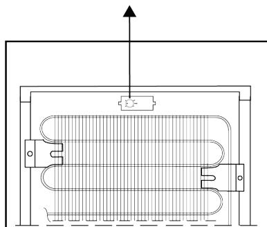
Il termostato si trova sulla parete posteriore dell'armadio (vedere foto sopra) ed è controllato dalla manopola del termostato.
