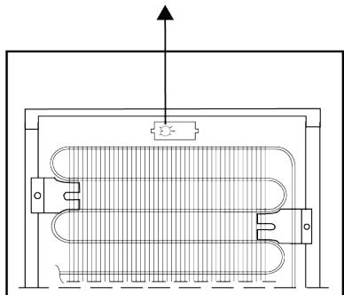
Termostat je umístěn na zadní stěně skřínky (viz obrázek výše) a ovládá se knoflíkem termostatu.
