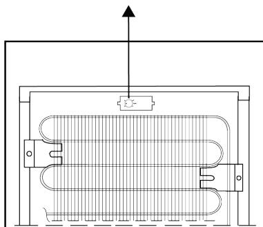
Termostat znajduje się na tylnej ściance (patrz: rysunek powyżej) i jest sterowany za pomocą pokrętła termostatu.
