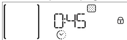
Une fois le cycle terminé, la porte reste verrouillée jusqu'à ce que la température à l'intérieur du four atteigne un niveau sécuritaire.
