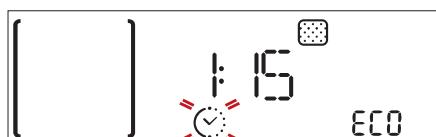
Rode o *botão de ajuste* para selecionar o ciclo pretendido e, em seguida, prima <sup>OK</sup> <sub>select</sub> para confirmar. O forno inicia o ciclo de limpeza automática e a porta do mesmo fecha-se automaticamente: é apresentada uma mensagem de aviso no visor, juntamente com uma contagem decrescente que indica o estado do ciclo em curso.
