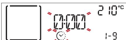
Lorsque le voyant  $\circ$  clignote à l'écran, utilisez le *bouton de réglage* pour régler le temps de cuisson désiré, et appuyez ensuite sur  $\frac{\text{OK}}{\text{select}}$  pour confirmer.
