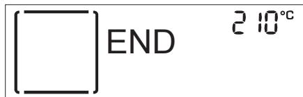
Prima **OK select** para continuar a cozedura no modo manual (sem um tempo de cozedura programado) ou rode o **botão de ajuste** para prolongar o tempo de cozedura, definindo uma nova duração. Em ambos os casos, as definições de temperatura ou do nível do grill serão mantidas.
