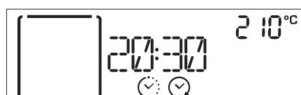
Remarques : La programmation d'un délai pour le début de la cuisson désactive la phase de préchauffage : Le four va atteindre la température désirée graduellement, ce qui signifie que les temps de cuisson vont être légèrement plus longs que ceux indiqués dans le tableau de cuisson.
