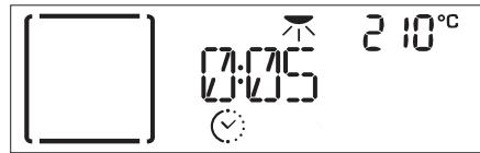
Per terminare in ogni momento, ruotare la *manopola di selezione* su 0 per spegnere il forno.
