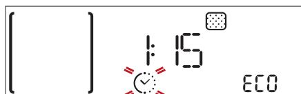
Tournez le *bouton de réglage* pour sélectionner le cycle désiré et appuyez sur OK pour confirmer. Le four commence un cycle d'auto-nettoyage et la porte se verrouille automatiquement : un message d'avertissement et le compte à rebours apparaissent à l'écran, indiquant le progrès du cycle.
