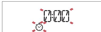
Nota: il timer non attiva nessun ciclo di cottura. Utilizzare la *manopola di regolazione* per modificare il timer, premendo **<<** è possibile disattivare il timer in ogni momento.
