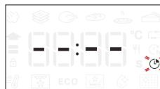
Wanneer het symbool knippert op de display, gebruik dan de instelknop om de gewenste bereidingstijd in te stellen en druk op om te bevestigen.
