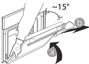
**3.** Ponovno postavite vrata pomičući ih prema pećnici, poravnavačući kuke šarki s ležistima i učvršćujući gornji dio na njegovo ležište.
