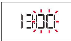
Števki za minute začneta utripati. Z obračanjem gumba nastavite minute in pritisnite za potrditev.
