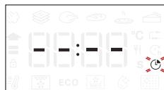
Cuando parpadee el ícono en la pantalla, utilice el selector de ajuste para ajustar el tiempo de cocción necesario y luego pulse para confirmar.
