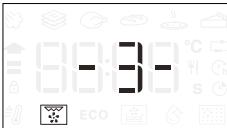
Bitte beachten: Nach dem Start der Funktion kann die Temperatur oder die Grillstufe durch Drücken von ⏪ oder direkt durch Drehen des Knopfes geändert werden.
