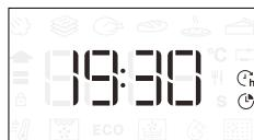
Nota: Programar una cocción con inicio diferido deshabilitará la fase de precalentamiento del horno: el horno alcanzará la temperatura deseada de forma gradual, con lo que los tiempos de cocción serán ligeramente mayores que los de la tabla de cocción.
