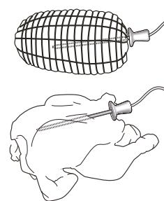
Es ist äußerst wichtig, den Fühler korrekt zu positionieren, um perfekte Garergebnisse zu erzielen. Den Kerntemperaturfühler vollständig in den fleischigsten Teil des Fleisches einführen, dabei Knochen und fettige Stellen vermeiden. Für Geflügel muss der Kerntemperaturfühler seitlich in die Mitte der Brust eingeführt werden. Dabei ist sicherzustellen, dass die Spitze nicht in einem Hohlraum steckt. Prüfen Sie im
