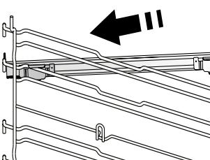
Uklonite vodilice rešetki iz pećnice i uklonite zaštitnu plastiku s kliznih vodilica.
