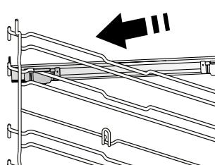
Die Seitengitter aus dem Ofen nehmen und den Kunststoffschutz von den Backauszügen entfernen.
