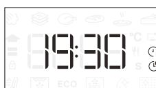
Remarque : La programmation d'un délai pour le début de la cuisson désactive la phase de préchauffage : Le four va atteindre la température désirée graduellement, ce qui signifie que les temps de cuisson vont être légèrement plus longs que ceux indiqués dans le tableau de cuisson.
