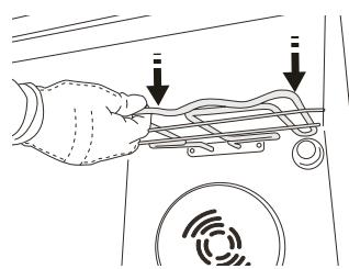
**3.** Um das Heizelement wieder korrekt einzusetzen, heben Sie es an und ziehen Sie es leicht zu sich her. Vergewissern Sie sich, dass es korrekt in den seitlichen Aussparungen sitzt.
