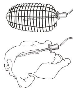
Il est très important de bien placer la sonde pour obtenir des résultats de cuisson parfaits. Insérez la sonde totalement dans la partie la plus pulpeuse de la viande, en évitant les os et les parties grasses. Pour la volaille, la sonde doit être insérée sur les côtés, au milieu de la poitrine, en veillant à ce que le bout de la sonde n'aboutisse pas dans une partie creuse. Si l'épaisseur de la viande est
