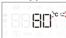
Pulse **OK** o **OK** para confirmar e iniciar el ciclo de cocción. Durante el ciclo de cocción, la pantalla muestra la temperatura programada para la sonda de carne. Cuando la carne alcanza la temperatura programada, el ciclo de cocción se detiene y en la pantalla aparece la palabra «End».
