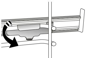
Da vodila zavarujete, spodnji del sponke čvrsto pritisnite na vodila za pekače. Prepričajte se, da je mogoče drsna vodila nemoteno premakniti. Postopek ponovite na drugem vodilu za pekače, ki je na enaki višini.
