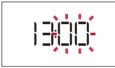
Op het display knipperen de twee cijfers die de minuten aangeven. Draai aan de knop om de minuten in te stellen en druk op om te bevestigen.
