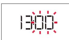
Les deux chiffres des minutes clignotent. Tourner le bouton pour régler les minutes et appuyer sur pour confirmer.
