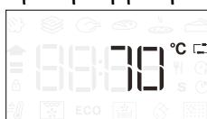
Πιέστε για έναρξη των ρυθμίσεων. Στρέψτε τον επιλογέα για να ρυθμίσετε τον αισθητήρα κρέατος στη στοχευόμενη θερμοκρασία. Πιέστε για επιβεβαίωση.
