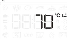
Pulse **OK** para iniciar los ajustes. Gire el selector para programar la temperatura prevista para la sonda de carne. Pulse **OK** para confirmar.
