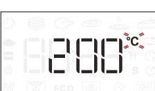
Kad ikona °C treperi na zaslonu, okrenite gumb za promjenu vrijednosti pa pritisnite za potvrdu te nastavite s promjenom sljedećih postavki (ako je moguće).
