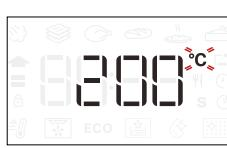
Wenn das Symbol °C auf dem Display blinkt, den Knopf drehen, um den Wert zu ändern, anschließend zur Bestätigung drücken und fortfahren, um die nachfolgenden Einstellungen zu ändern (falls möglich).
