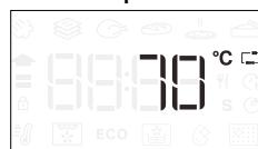
Appuyez sur **④** pour démarrer les réglages. Tournez le bouton pour régler la température cible de la sonde à viande. Appuyez sur **④** pour confirmer.
