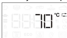
Pritisnite da biste započeli postavke. Okrenite dugme da biste podesili željenu temperaturu sonde za meso. Pritisnite za potvrdu.
