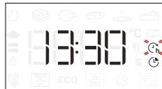
Si es necesario, gire el selector para configurar la hora a la que quiere que termine la cocción y pulse para confirmar e iniciar la función.
