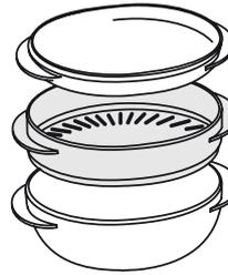
Zum Dämpfen von Fisch oder Gemüse, die Speise in den Korb (2) geben und zur Erzeugung der korrekten Menge an Dampf, Trinkwasser (100 ml) in den Boden des Dampfeinsatzes (3) füllen.
