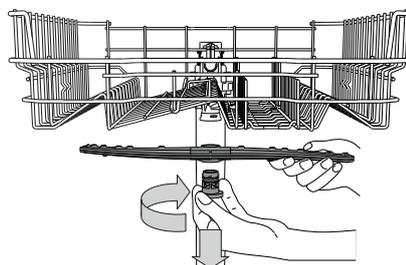
Per smontare il braccio aspersore superiore, ruotare l'anello di bloccaggio in plastica in senso orario. Il rimontaggio del braccio aspersore deve avvenire in modo che il lato con il maggior numero di fori sia rivolto verso l'alto.
