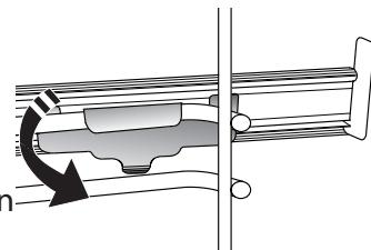
Um die Führungen zu sichern, den unteren Teil des Clips fest gegen das Seitengitter drücken. Sicherstellen, dass sich die Backauszüge frei bewegen können. Diese Schritte am anderen Seitengitter auf der gleichen Einschubebene wiederholen.
