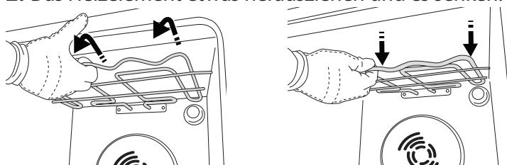
3. Um das Heizelement wieder korrekt einzusetzen, heben Sie es an und ziehen Sie es leicht zu sich her. Vergewissern Sie sich, dass es korrekt in den seitlichen Aussparungen sitzt.
